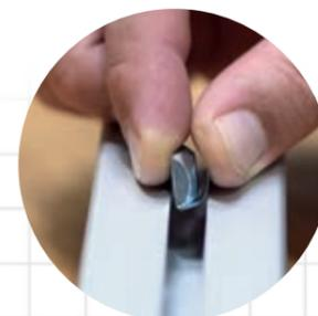
1. Gleitmutter in Nut einschieben
