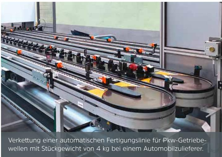
Verkettung einer automatischen Fertigungslinie für Pkw-Getriebewellen mit Stückgewicht von 4 kg bei einem Automobilzulieferer.
