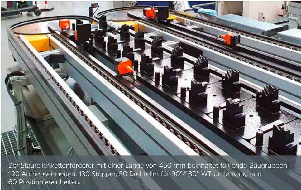
Der Staurollenkettenträger mit einer Länge von 450 mm beinhaltet folgende Baugruppen: 120 Antriebseinheiten, 130 Stopper, 50 Drehteller für 90°/180° WT Umlenkung und 60 Positioniereinheiten.
