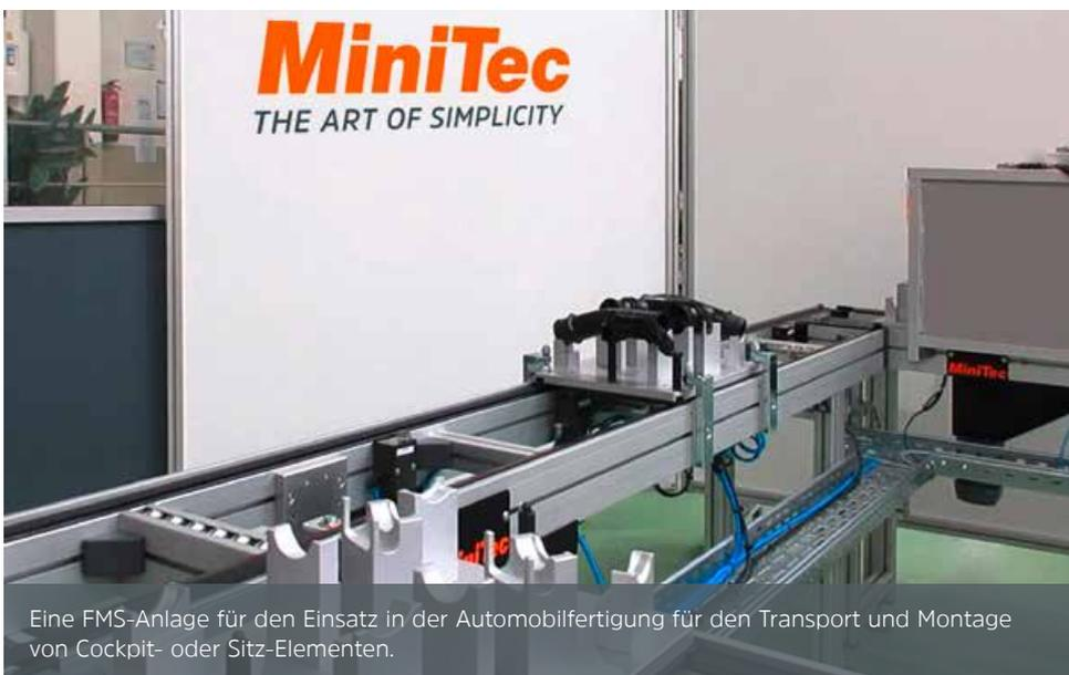
Eine FMS-Anlage für den Einsatz in der Automobilfertigung für den Transport und Montage von Cockpit- oder Sitz-Elementen.
