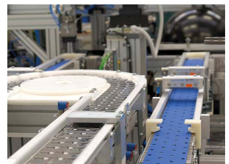
Förderer mit verknüpften Gliederketten sind ideal geeignet für kurvige Strecken, Steigungen oder komplexe Layouts.
