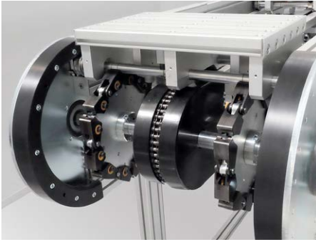
Das Palettenumlaufsystem UMS und UMS Light wurde speziell für kompakte Montage- und Automatisierungszellen entwickelt.
