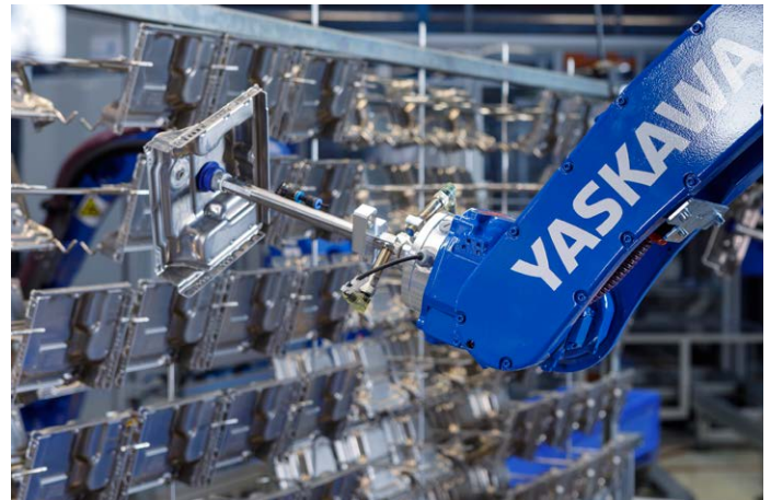
Eine Kameraprüfung bei der Entnahme sorgt dafür, dass die Bauteile in den Kleinladungsträgern korrekt platziert werden.
