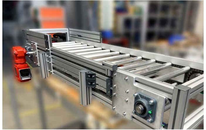
Kettengetriebene Förderstrecke für den Transport von Elektromotorrotoren
