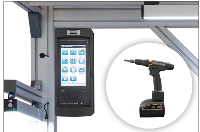
Mit dem neuen Modul lassen sich Schraubvorgänge über das Assistenzsystem steuern und Folgeaktionen aufgrund der Ergebnisse auslösen.
