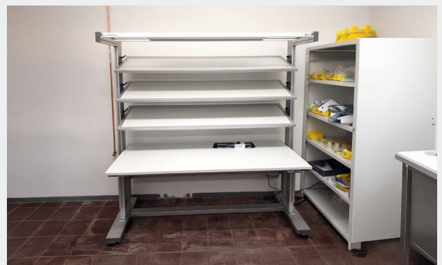
Höhenverstellbarer ESD-Tisch mit verstellbaren Regalen und integrierter Beleuchtung.
