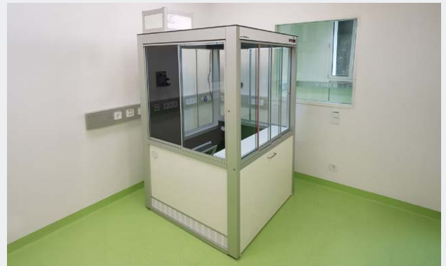
Geräteeinhausung für Massenspektrometer mit geregelter Abluft und Schallschutz.
