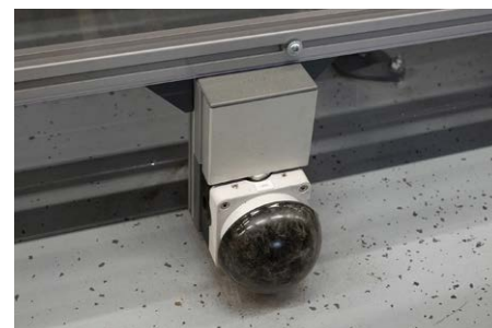
Fußschalter zum Weiterbewegen der Werkstückträger.
