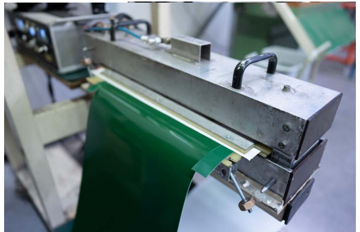
Eine Fügepresse sorgt für stabile Endverbindungen.
