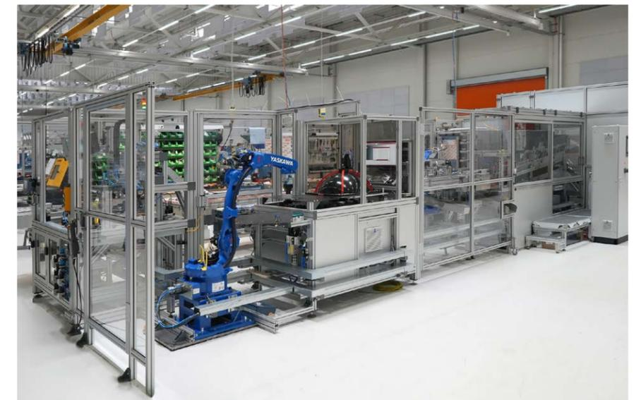
Roboter können Werkstücke zu stationären Qualitätsprüfsensoren bewegen.
