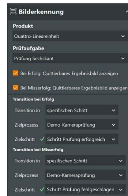
Konfiguration der Bildererkennung im Editor MiniTec SmartEdi.
