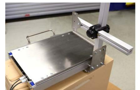
Auch kleinere Standardgeräte, wie ein Markiersystem, entstehen auf Basis des MiniTec-Baukastens.
