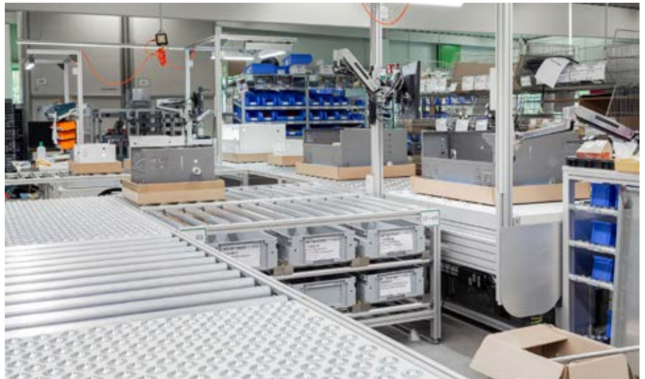
Rollengänge und Kugelrolltische für den Transport der Werkstücke zwischen den Arbeitsstationen.
