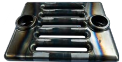
Keine Nachbearbeitung nötig: Das flussmittelfreie Löten liefert ein sauberes Resultat.
