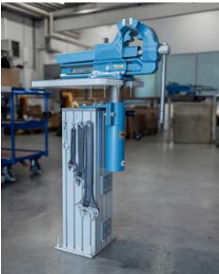
Sonderlösung: Höhenverstellbarer Schraubstock.
