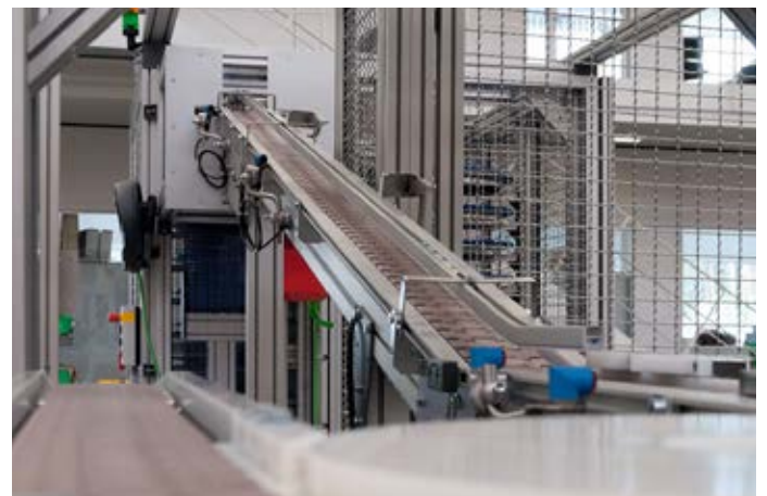
Gliederkettenförderer eignen sich besonders für große und komplexe Anlagen.
