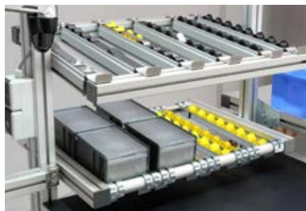
Eine besonders variable Lösung für Kanban ermöglicht das flexible Rollenträger-System.
