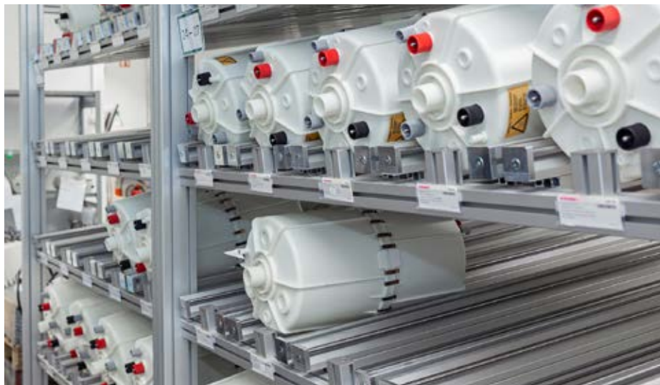
Das rollbare Lagerregal erlaubt ein leichtes Verschieben der Regalplätze.
