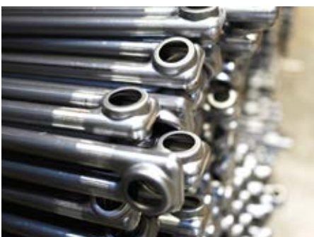
Die fertig gelöteten Elemente kommen zunächst ins Zwischenlager.
