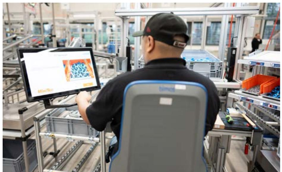
Per Touch-Bildschirm wird der Werker Schritt für Schritt durch den Montageprozess geleitet.
