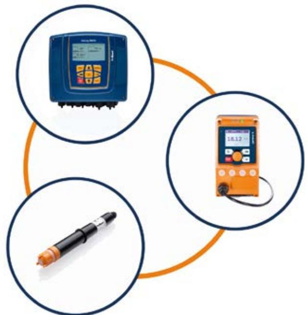
Der Regelkreis des ProMinent-Systems: Der Sensor misst den Gehalt des Desinfektionsmittels im Wasser und gibt die Daten an den Regler weiter. Dieser sagt der Pumpe, wie viel sie nachdosieren oder reduzieren soll.
