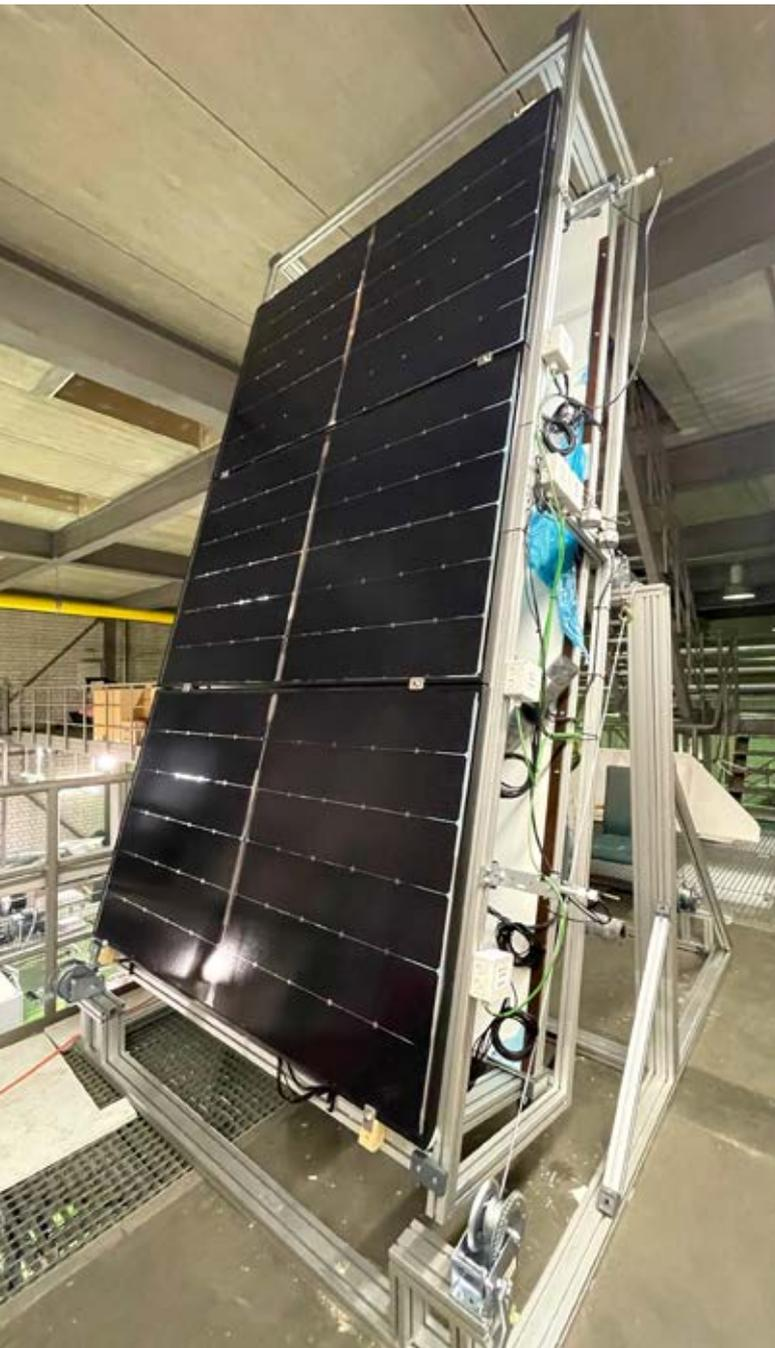
Der Fachbereich Energie und Information der HTW Berlin ermittelt mit einem Testaufbau den optimalen Hinterlüftungs-Abstand von PV-Modulen.
