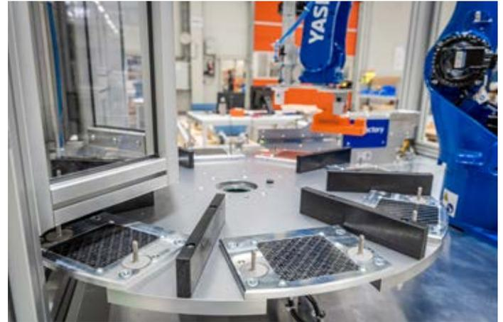
Die Werkstücke für das Hybridschweißen werden in der Roboterzelle in einem Rundtaktisch transportiert.
