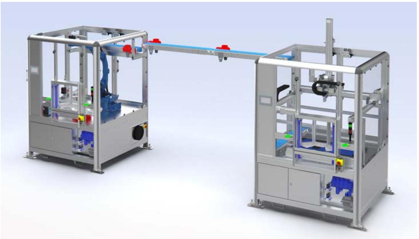
Durch die Verkettung von Fertigungszellen lassen sich vollautomatische Produktionslinien realisieren.
