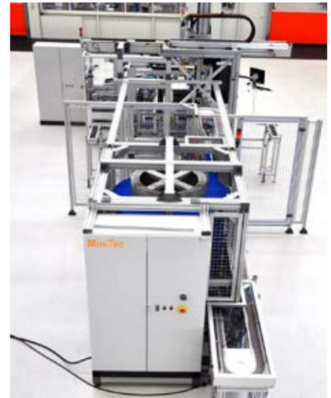
Dank der Pufferkapazität des Wendelförderers können Fertigungsmaschinen völlig autark beschickt und somit die Fertigung weiter automatisiert werden.
