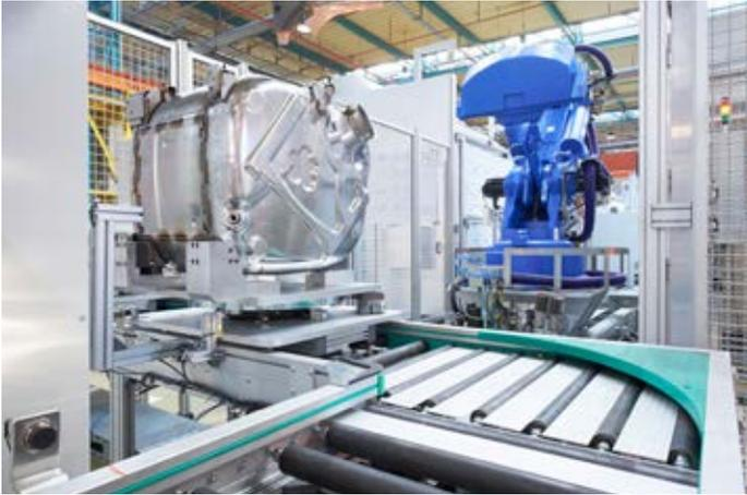
Das Werkstückträger-Transfersystem RMS wurde für den Schwerlasttransport konzipiert.
