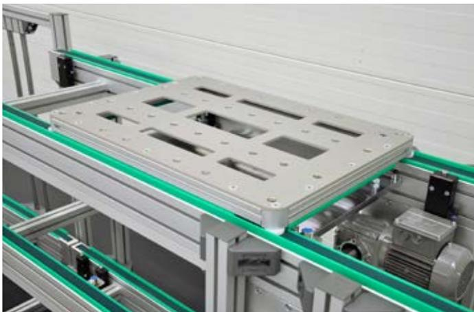
Das Transfersystem TSG basiert auf standardisierten Modulen und ist eine besonders wirtschaftliche Lösung für geringe Stückgewichte.
