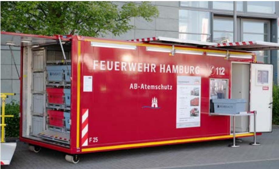
Der Vorteil von Abrollbehältern ist, dass sie unabhängig vom Transportfahrzeug zur Be- oder Entladung beziehungsweise Nutzung abgestellt werden können.
