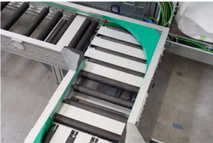
Das Delta-Umlenksystem ermöglicht beim RMS den unterbrechungsfreien Kurventransport.
