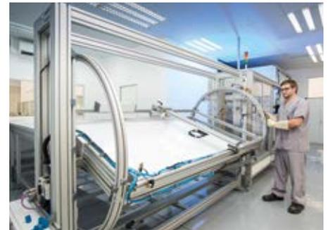
Eine Aufricht- beziehungsweise Reinigungsstation für die PV-Module.
