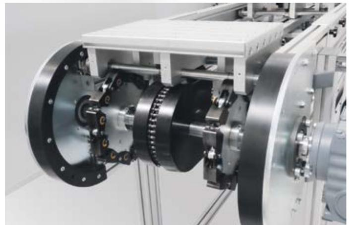
Das Palettenumlaufsystem UMS dient der Verkettung von Bearbeitungsmaschinen, Arbeitsplätzen, Handhabungsgeräten oder Roboter-Zuführungen.
