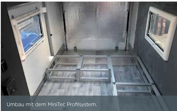
Umbau mit dem MiniTec Profilsystem.
