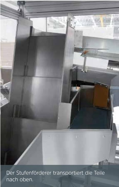
Der Stufenförderer transportiert die Teile nach oben.
