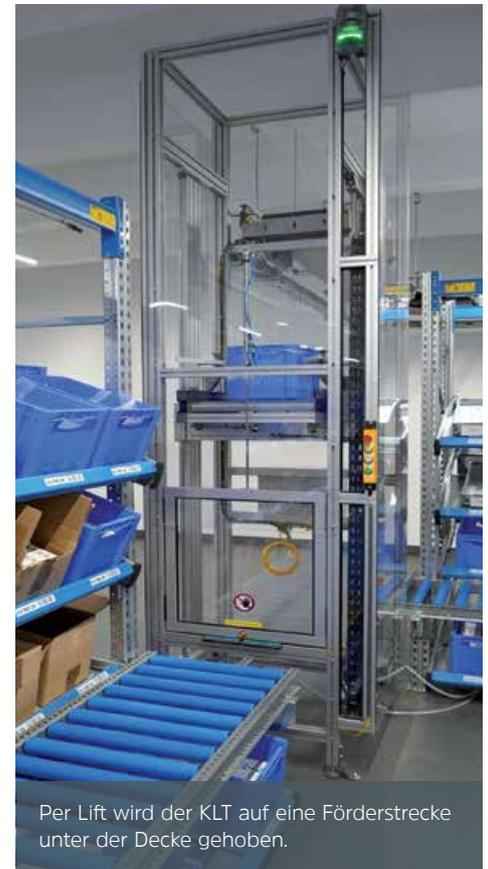
Per Lift wird der KLT auf eine Förderstrecke unter der Decke gehoben.
