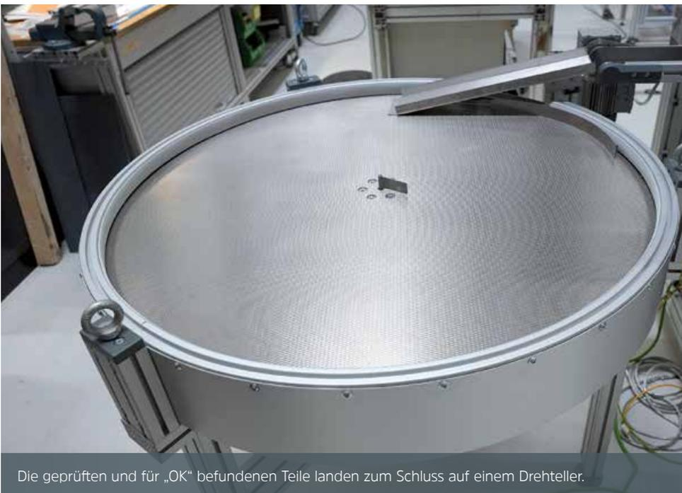
Die geprüften und für „OK“ befundenen Teile landen zum Schluss auf einem Drehteller.
