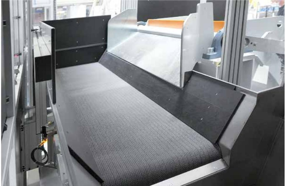
Von hier aus gehen die Teile per Förderband zu einem Stufenförderer.
