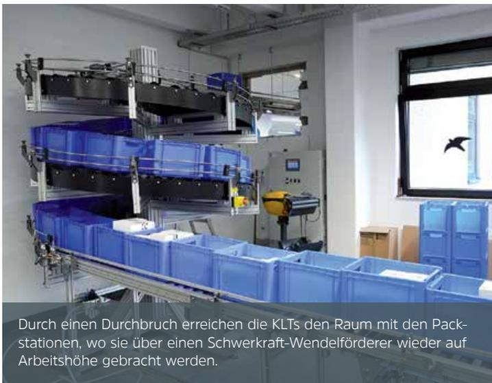
Durch einen Durchbruch erreichen die KLTs den Raum mit den Packstationen, wo sie über einen Schwerkraft-Wendelförderer wieder auf Arbeitshöhe gebracht werden.
