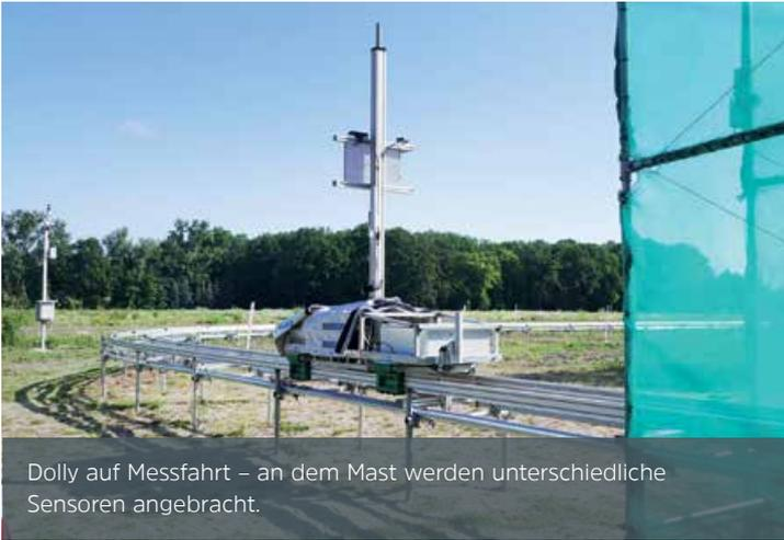
Dolly auf Messfahrt – an dem Mast werden unterschiedliche Sensoren angebracht.
