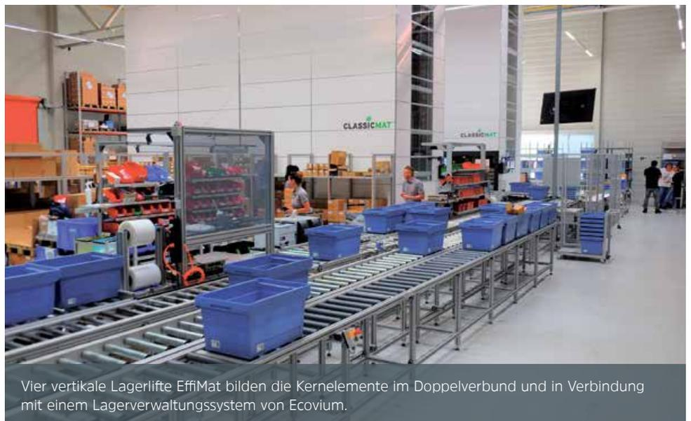
Vier vertikale Lagerlifte EffiMat bilden die Kernelemente im Doppelverbund und in Verbindung mit einem Lagerverwaltungssystem von Ecovium.
